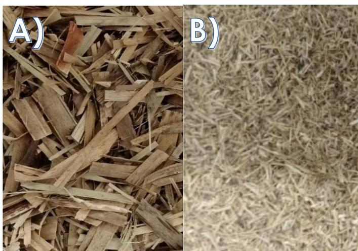
Figura 12: Amostra de palha de cana-de-açúcar *in natura* nas duas granulometrias analisadas, A) cortada (aproximadamente 2 cm) e B) moída (850 - 180  $\mu\text{m}$ )
