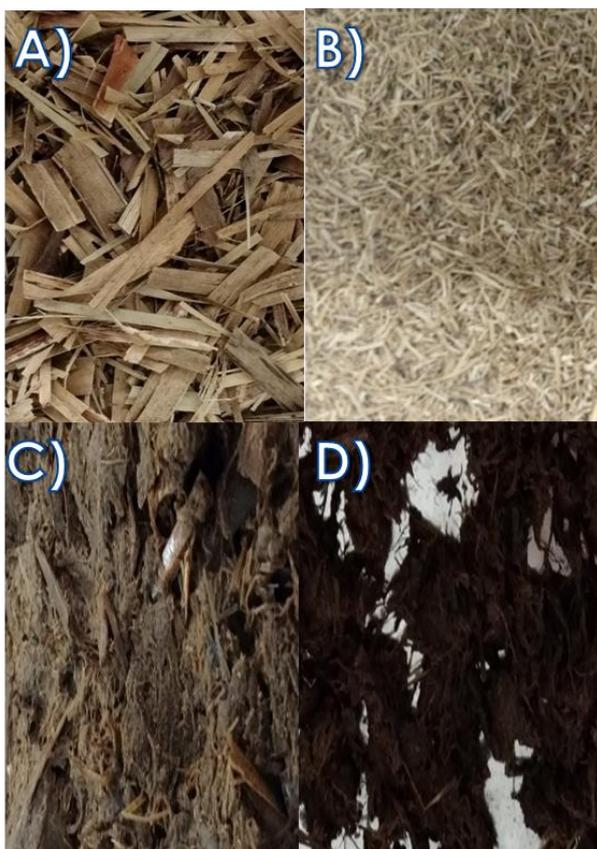
Figura 14: Amostras de palha de cana-de-açúcar *in natura* e após o PTH, cortadas e moídas. A) *in natura* cortada; B) *in natura* moída; C) PTH cortado; D) PTH moído.
